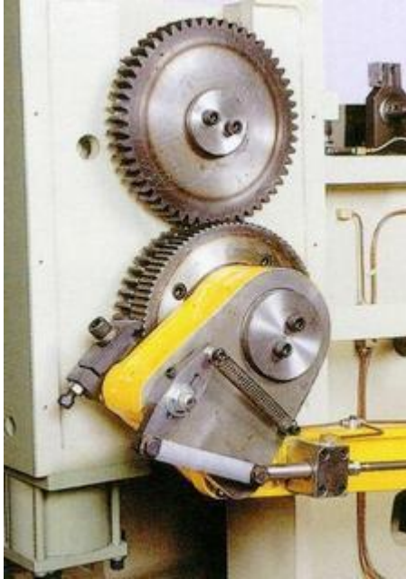
Валки обеспечивают подачу заготовки для высадки болтов малых размеров.
