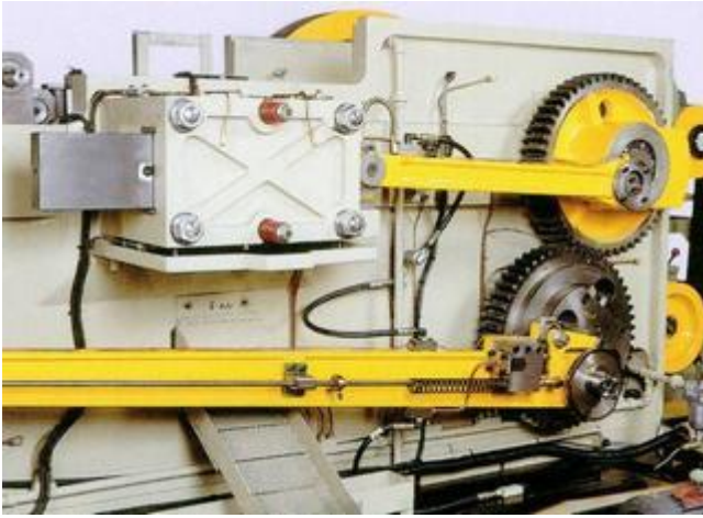
Механизм отключения питания с системой S-CAM управляется коленчатым валом в горизонтальной плоскости.
